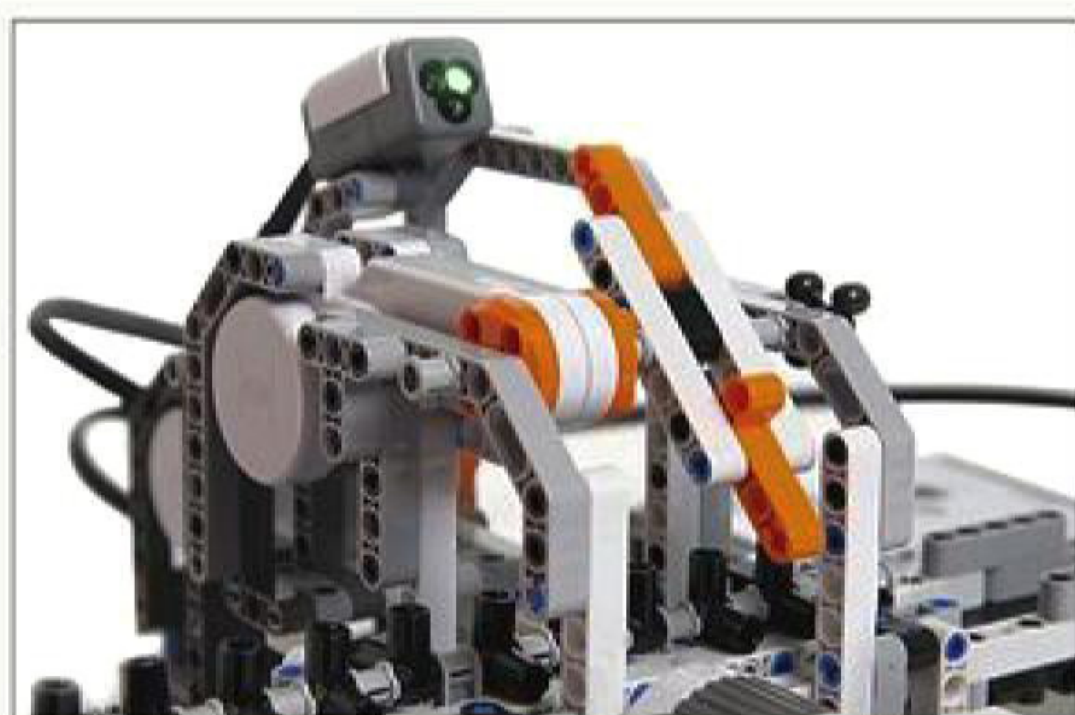
▲ Собранная энтузиастами из конструктора LEGO машина Тьюринга теоретически способна решать те же задачи, что и современный компьютер
