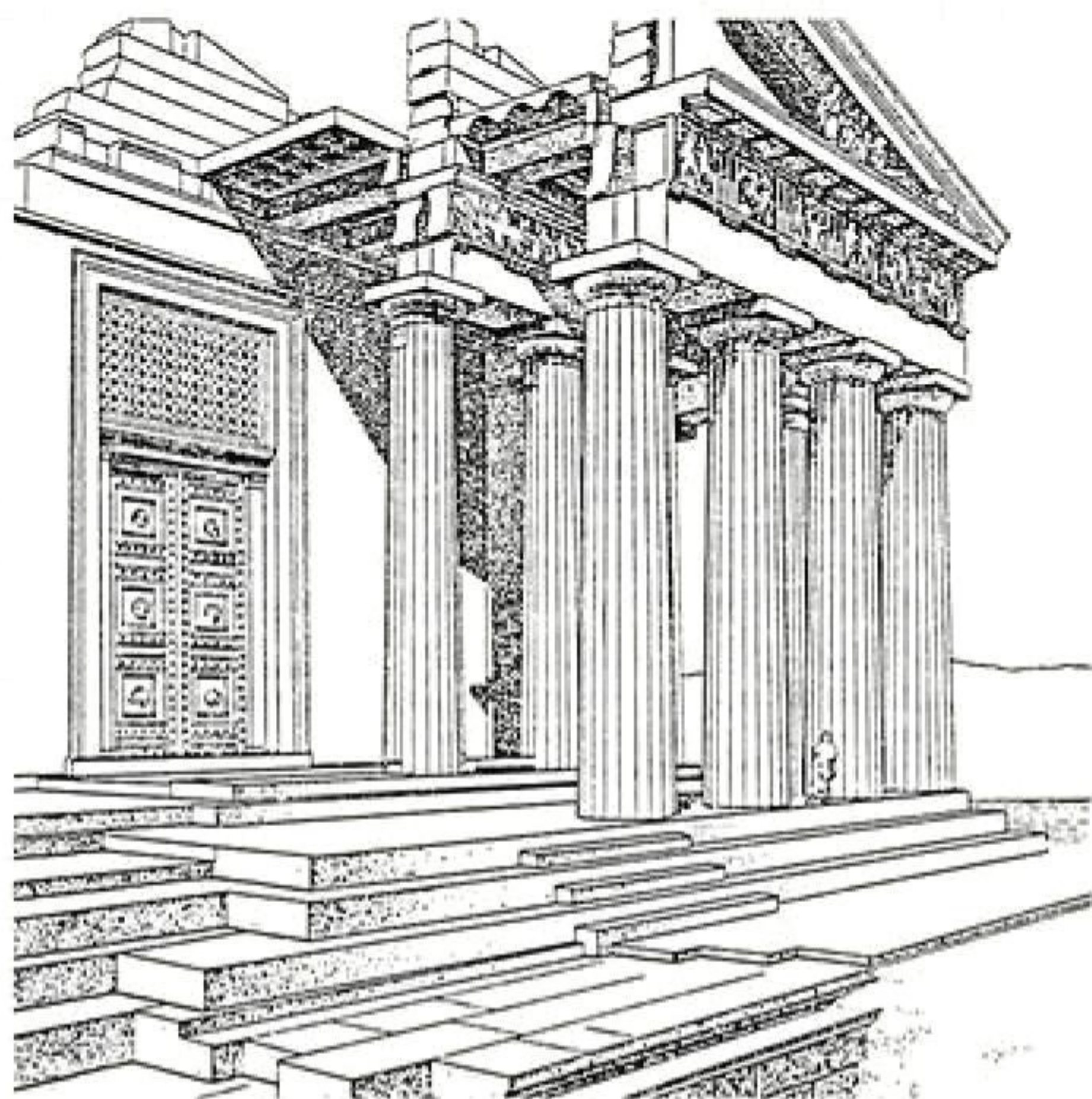
Стойчно-балочная система перекрытий Афинского акрополя: стойки – колонны, балки – архитравы
